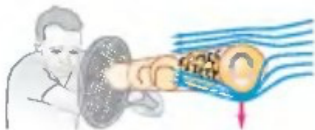
(d) Spin pushing a tennis ball downward
