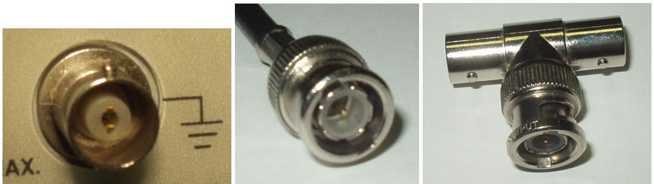
Slika 3: BNC utičnica, BNC utikač i BNC razdjelnik.
