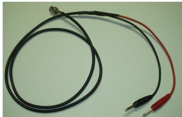
Slika 5: Koaksijalni kabel s razdvojenim vodičima u "banana" utikače. Vanjski (uzemljeni) vodič je spojen na crni utikač.
