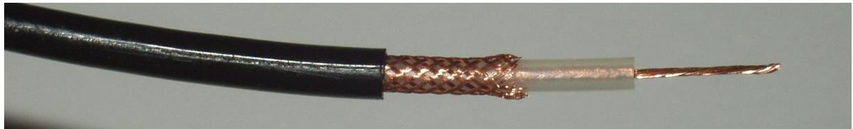
Slika 4: Struktura koaksijalnog kabela.
