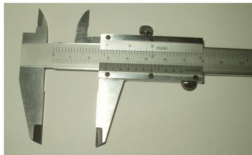
Slika 1: Pomična mjerka.
