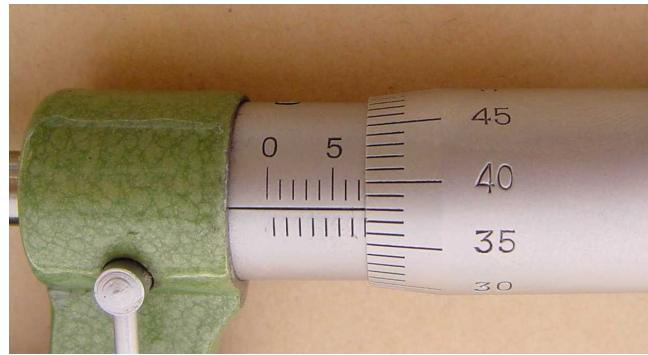
Slika 5: Uvećani prikaz skale mikrometarskog vijka.
