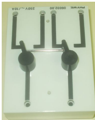
Slika 4: Preklopnik za naizmjenično mjerenje napona.
