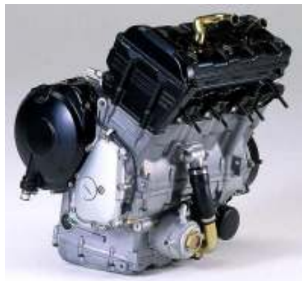
Slika 7 – Četverocilindrični četverotaktni agregat (1000 ccm) natjecateljskog motocikla
