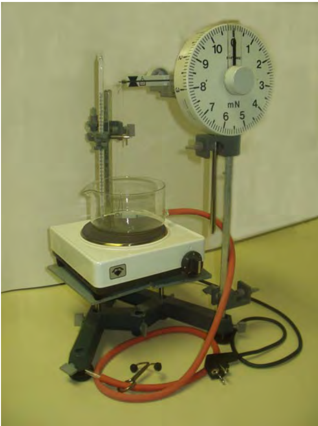
Slika 4. Mjerni postav za metodu otkidanja prstena
