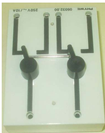
Slika 3b. Preklopnik za naizmjenično mjerenje napona
