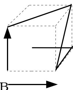
Po zamišljenoj kocki stranice 75cm postavljen je vodič kojim teče struja jakosti  $6,58\text{A}$  kako je prikazano na slici. U prostoru vlada homogeno magnetsko polje od  $0,86\text{T}$  u smjeru navedenom na slici. Kolika je ukupna sila (iznos i smjer) na ovako isavijani vodič?
