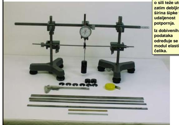
Mjeri se ovisnost savijenosti šipke o sili teže utega, zatim debljina i sirina šipke te udaljenost potporne.
