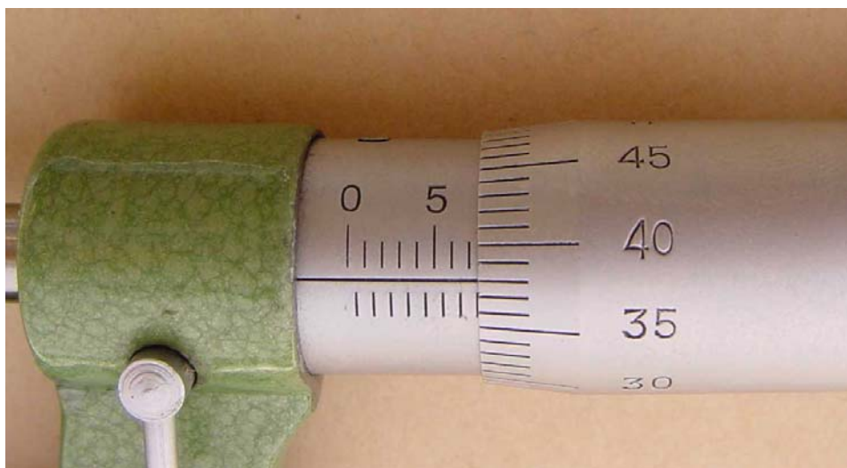
Slika 4. Uvećani prikaz skale mikrometarskog vijka
