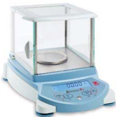
Slika 5. Precizna vaga s točnošću od 1 mg
