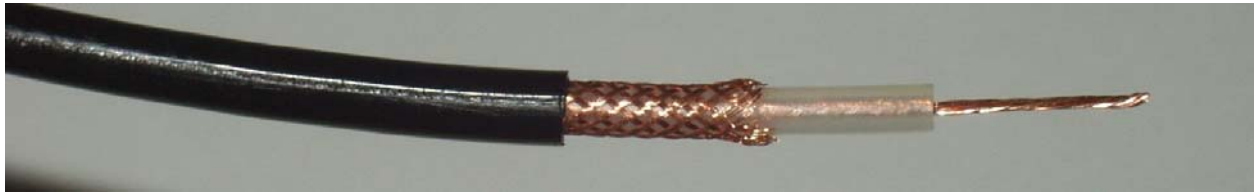
Slika 4a. Struktura koaksijalnog kabela.
