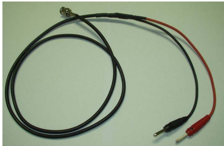
Slika 4b. Koaksijalni kabel s razdvojenim vodičima u "banana" utikače. Vanjski (uzemljeni) vodič je spojen na crni utikač.
