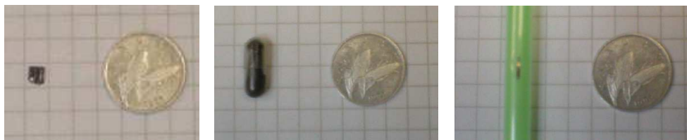
Slika 5.3: Uzorci pripremljeni za magnetsko mjerenje. Lijevo je monokristal Mn_{12} -acetata na silicijevoj pločici, u sredini magnetske nanočestice s parafinom u ampuli, a desno Hf-Fe slitina na slamci. U pozadini je kvadratna mreža od 5mm.
