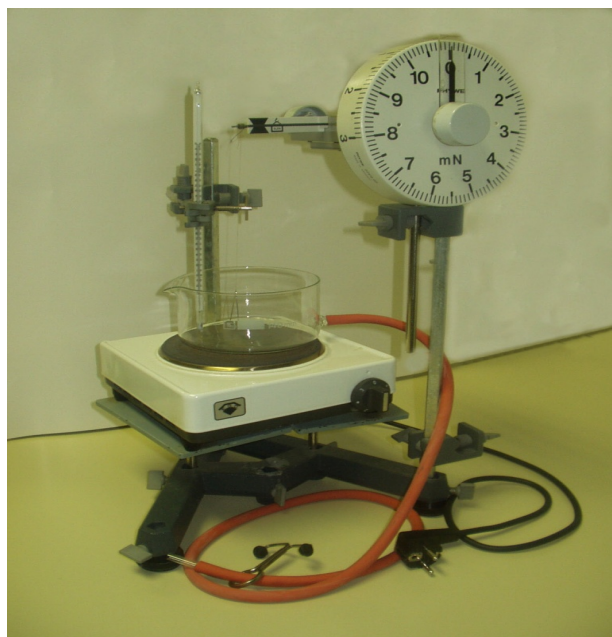
Slika 4. Slika 4. Mjerni postav za metodu otkidanja prstena
