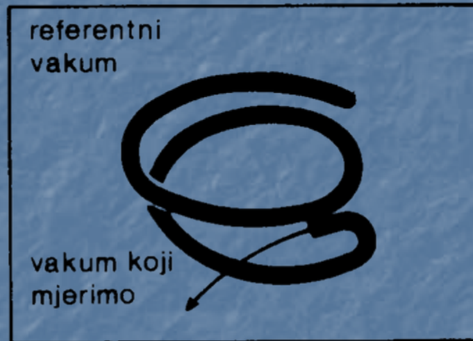
Slika 7.4. Bourdonova cijev. Spiralna konstrukcija cijevi osigurava da se cijev odmata ili namata ovisno o tome je li u njoj tlak povećan ili umanjen.
