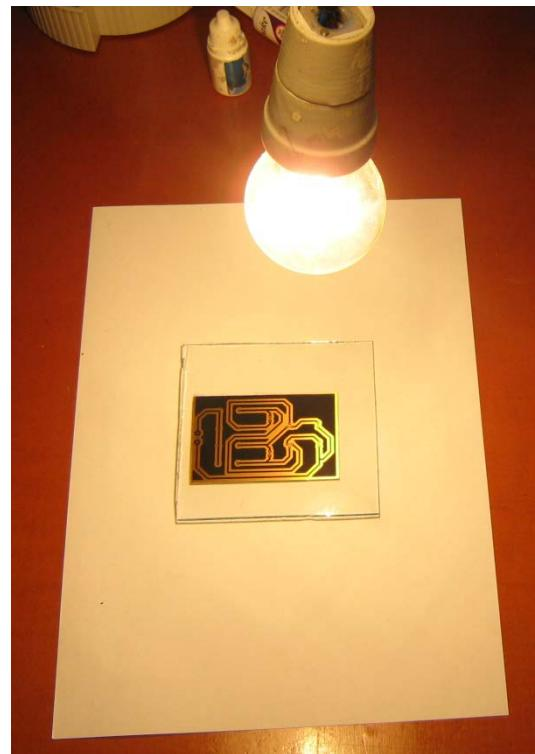
Nakon što je pločica osvijetljena, potrebno je osvijetljeni fotolak sa pločice razviti pomoću fotorazvijača. Ukoliko je koncentracija fotorazvijača dovoljno velika lak bi se trebao razviti unutar jedne minute, nakon čega je potrebno pločicu isprati vodom i dobro osušiti. Kada je pločica osušena možemo započeti sa jetkanjem pločice. Ovaj je postupak relativno dugotrajan, ali i relativno opasan, pa je potrebno dodatno обратити pažnju na sigurnost.
