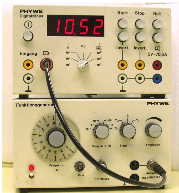
Slika 4. Mjerač frekvencije i izvor izmjeničnog signala
