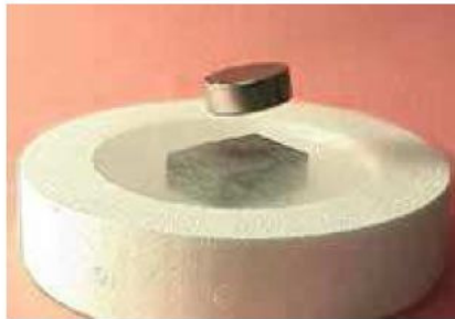
Primjer levitiranja malog magneta iznad suravodiča
