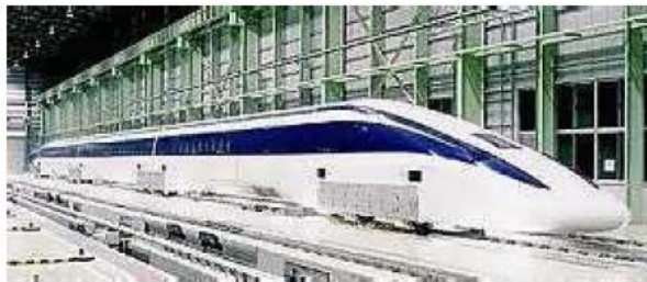
Magnetsko levitirajući (MagLev) vlak "Yamanashi MLX01" (brzina 581 km/h)
