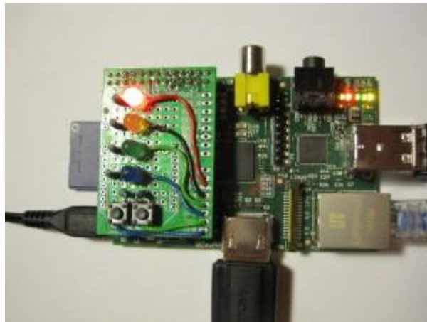
Slika 9: Ploča i upaljena LED lampa nakon unošenja koda [6]
